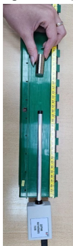
Рис. 3. Демонстрация зависимости модуля вектора магнитной индукции от расстояния до магнита
