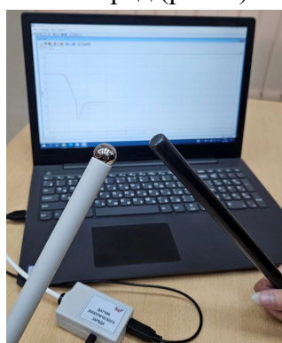
Рис. 1. Демонстрация возникновения отрицательного заряда на эбонитовой палочке, потертой о мех
